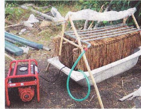
①塩田に海水をまくクサンバ村の男性 ②海水をポンプでくみ上げ、わらの上から流す流下式のモデル装置 ③いずれもインドネシア・バリ島で
